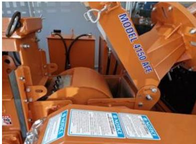
Рис. 6.15.1 Крышка барабана
