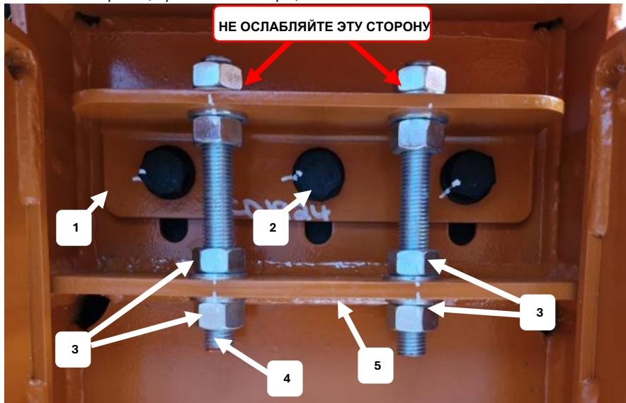
Рис. 6.9.6 Контрнож - вид снизу.
