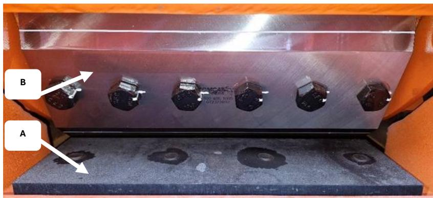
Рис. 6.9.4 Правильно установленный контрнож с зазором 3 мм. Контрнож (А) и нож (Б) (только для иллюстрации)
