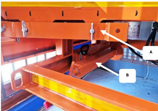
Рис. 6.8.2 Шаг 2. А = Инструмент для подъема подвижного блока, В = Домкрат
