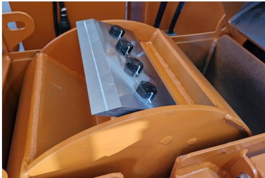
Рис. 6.14.1 Закрепленный на барабане нож измельчителя TOMCAT модель 4150
