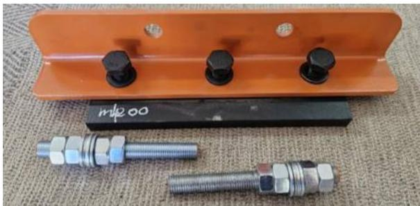
Рис. 6.9.5 Контрнож с комплектом крепежа.
