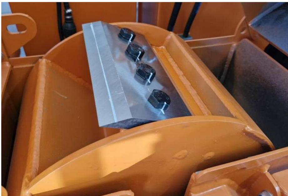
Рис. 6.14.1 Закрепленный на барабане нож измельчителя ТОМСАТ модель 4150
