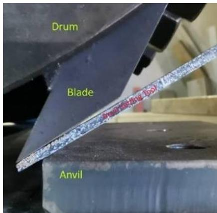
Рис. 6.9.1 Зазор контножа - вид сбоку
