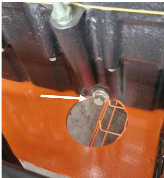
Рис. 6.1.5 Заглушка картера двигателя со сливом
