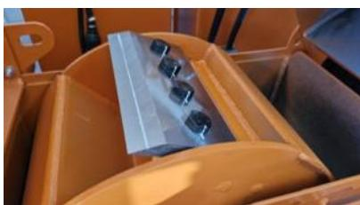
Рис. 6.15.4 Барабан и нож измельчителя
