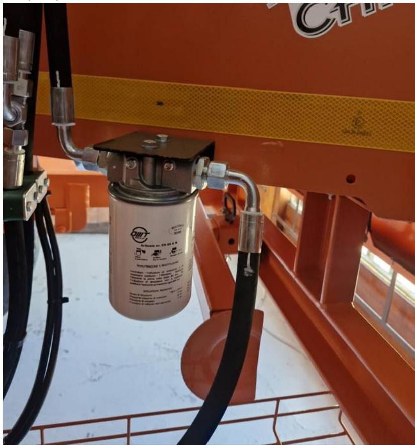
Рис. 6.12.1 Гидравлический фильтр возвратный
