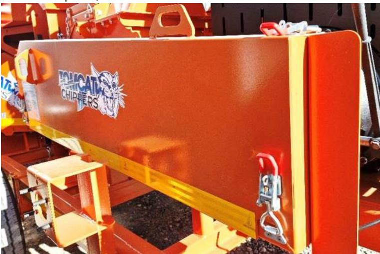
*Рис. 6.4.1 Крышка ремней привода*
