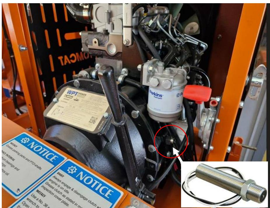
*Рис. 6.2.1 Расположение магнитного датчика (отмечено красным цветом)*
