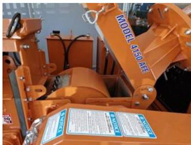
Рис. 6.15.1 Крышка барабана
