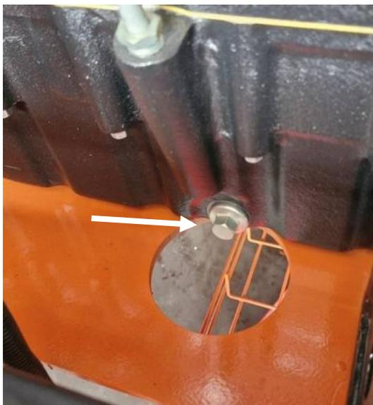
Рис. 6.1.5 Заглушка картера двигателя со сливом
