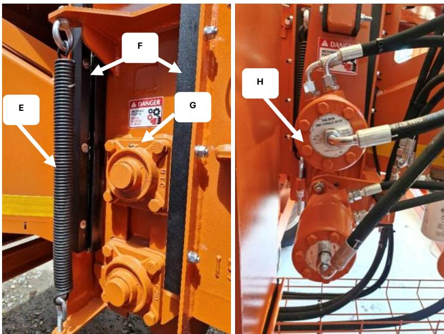
Рис. 6.6.3 Пружины подвижного блока (Е), Износостойкие накладки (F), Фланцевый подшипник 210 (G), гидромоторы BMR (H)
