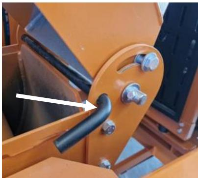
Рис. 6.15.3 Открытая крышка барабана при зафиксированном стопорном штифте
