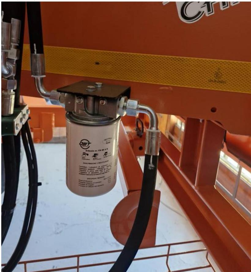
Рис. 6.12.1 Гидравлический фильтр возвратный
