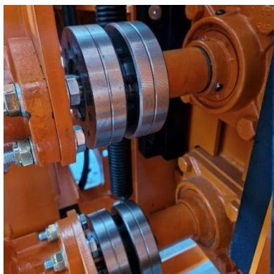
*Рис. 6.10.1 Соединительные муфты Climax*
