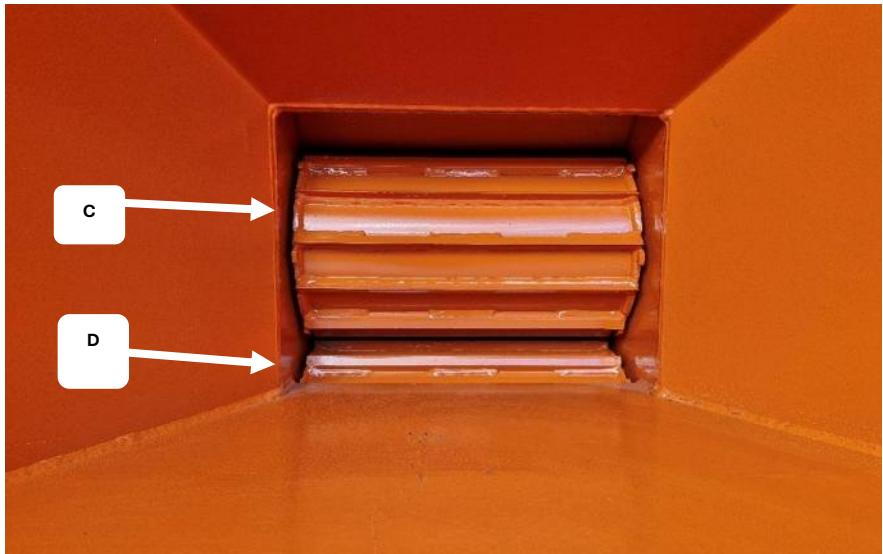
Рис. 6.6.2 Верхний питающий ролик (С) и нижний питающий ролик (D) со стороны бункера
