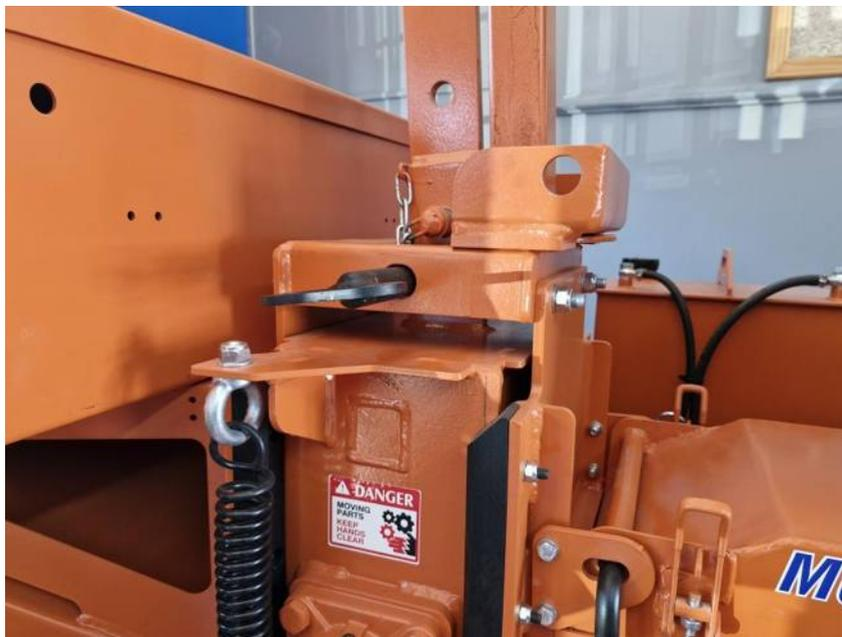
Рис. 6.8.8 Подвижный блок, закрепленный стопорным штифтом
