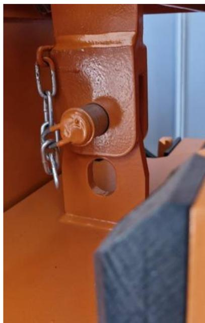
*Рис. 6.8.6 Зафиксируйте инструмент с помощью штифта*
