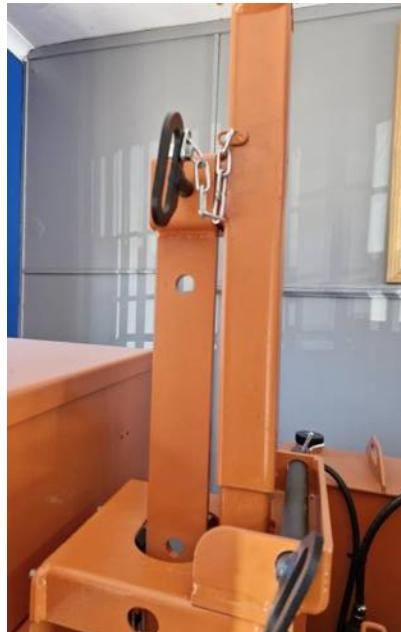
Рис. 6.8.5 Зафиксируйте домкратную планку
