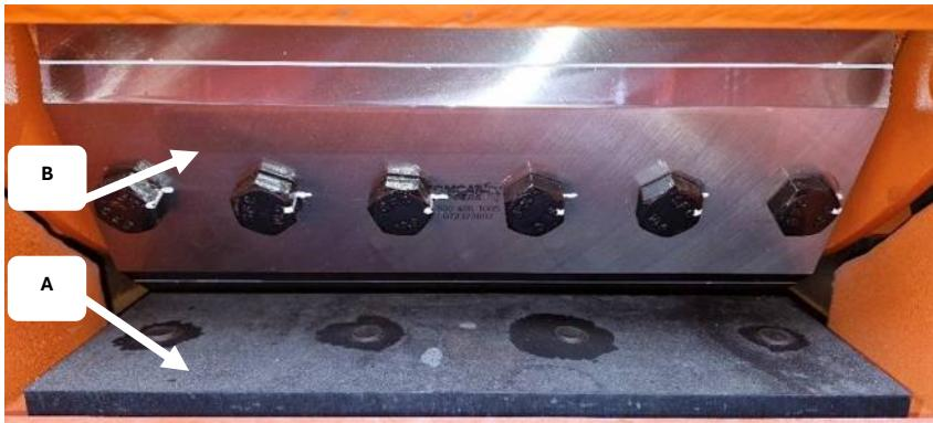
Рис. 6.9.4 Правильно установленный контнож с зазором 3 мм.
