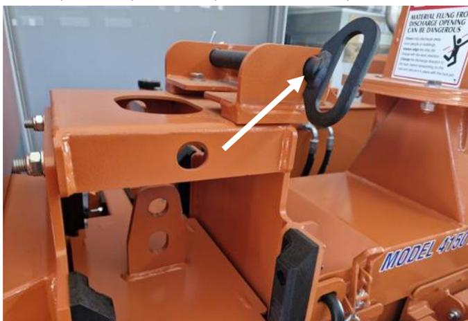
Рис. 6.8.1 Стопорный штифт подвижного блока
