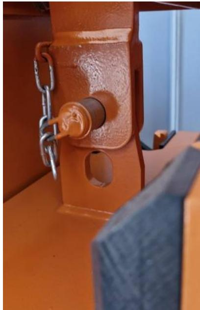
Рис. 6.8.6 Зафиксируйте инструмент с помощью штифта
