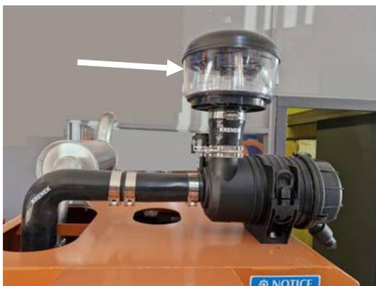
Рис. 6.1.7 Корпус воздушного фильтра и чаши циклонного фильтра
