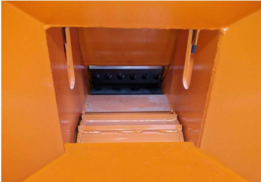
Рис. 6.8.7 Горловина подачи при открытом подвижном блоке
