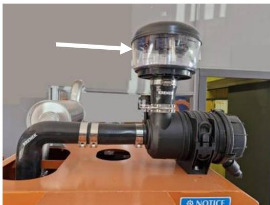
Рис. 6.1.7 Корпус воздушного фильтра и чаша циклонного фильтра
