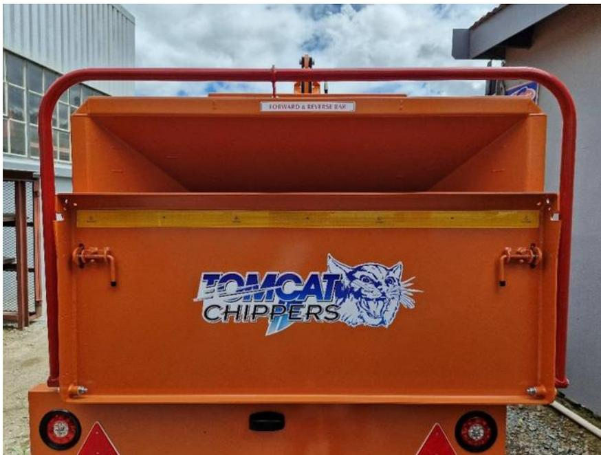
*Рис. 6.16.1 Предохранительная планка затягивания и реверса*
