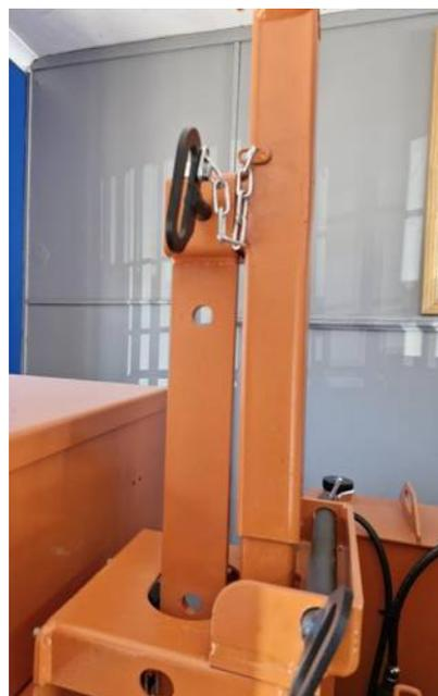
*Рис. 6.8.5 Зафиксируйте домкратную планку*
