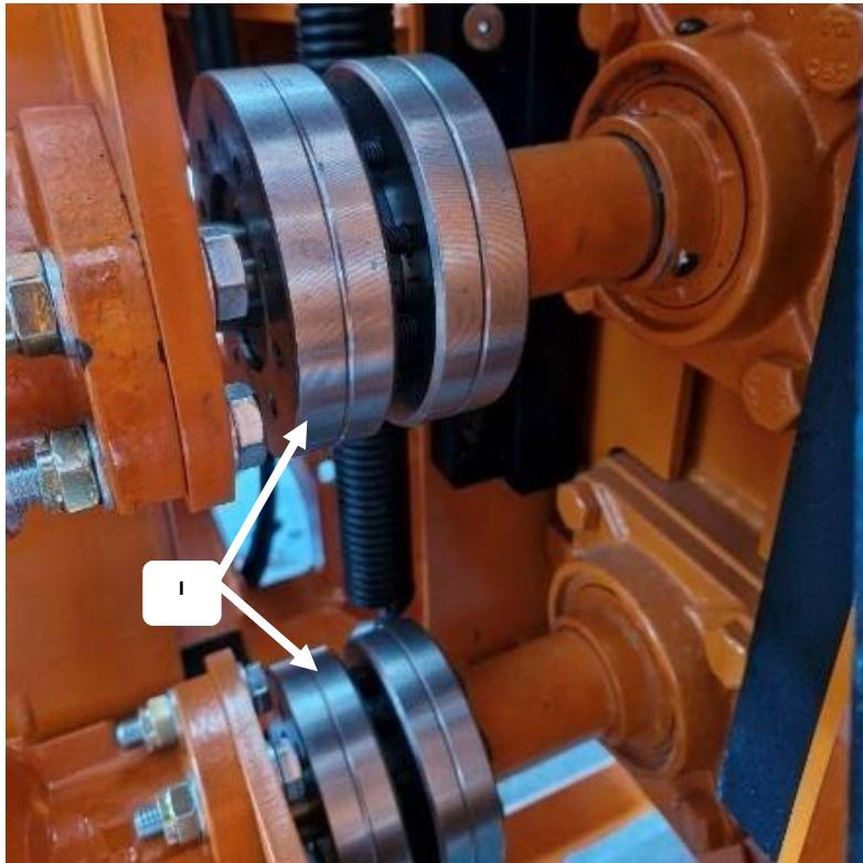
Рис. 6.6.4 Соединительные муфты Climax (I)
