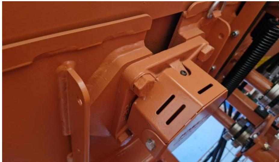
Рис. 6.11.1 Подшипник главного барабана
