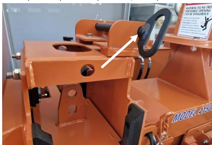
*Рис. 6.8.1 Стопорный штифт подвижного блока*
