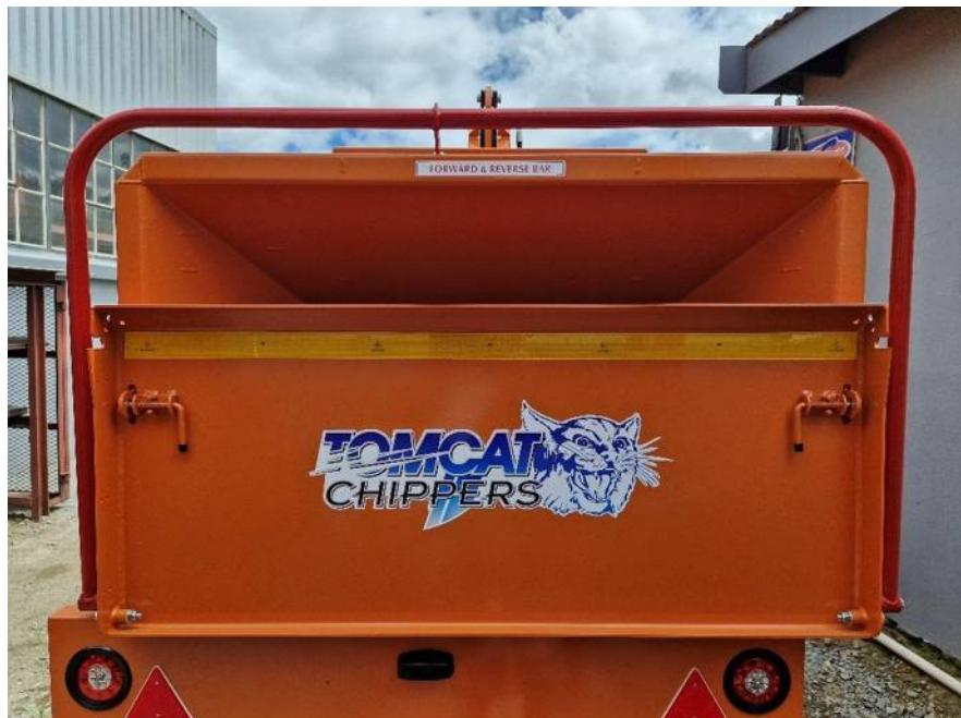
*Рис. 6.16.1 Предохраниительная планка затягивания и реверса*
