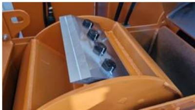
Рис. 6.15.4 Барабан и нож измельчителя
