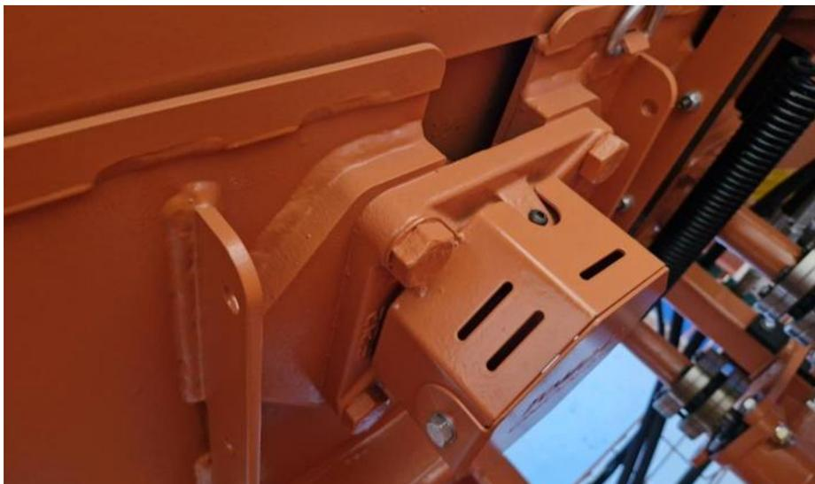
Рис. 6.11.1 Подшипник главного барабана
