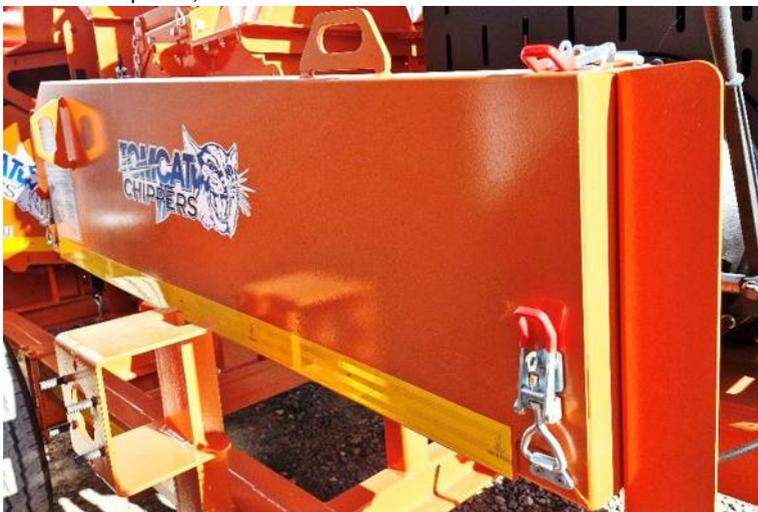
Рис. 6.4.1 Крышка ремней привода
