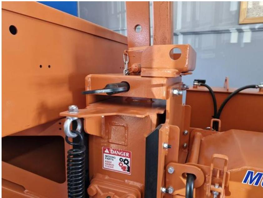
Рис. 6.8.8 Подвижный блок, закрепленный стопорным штифтом
