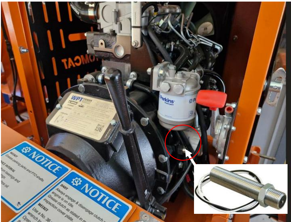
Рис. 6.2.1 Расположение магнитного датчика (отмечено красным цветом)
