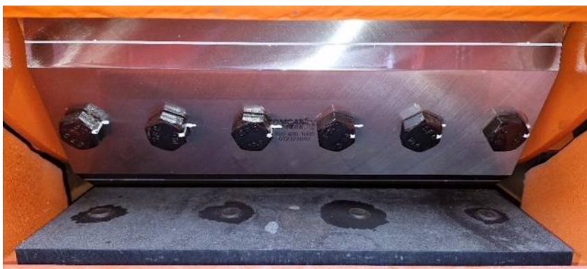
Рис. 6.10.4 Правильно установленный контрнож с зазором 3 мм
