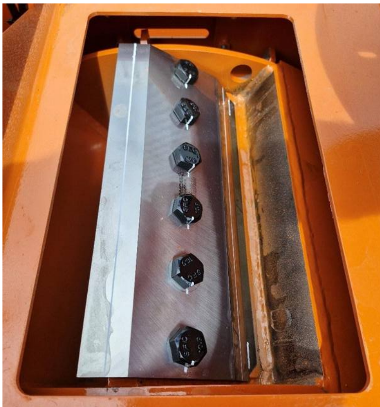
Рис. 6.15.1 Закрепленный на барабане нож измельчителя ТОМКАТ модель 4250
