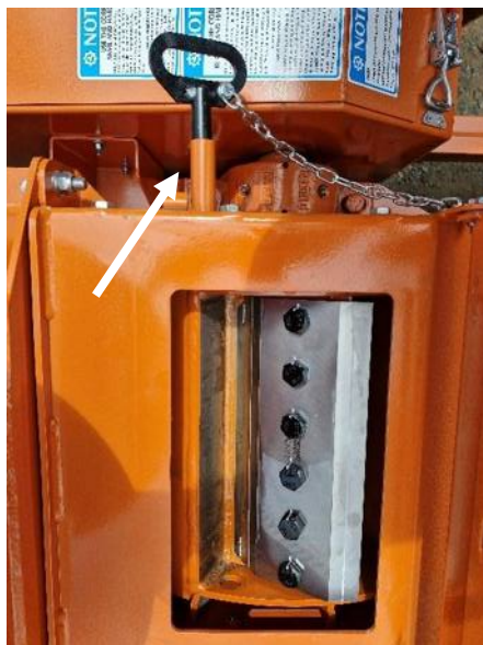
Рис. 6.16.3 Открытая крышка барабана при зафиксированном стопорном штифте
