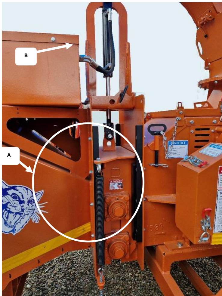
Рис. 6.6.1 Подвижный блок питателей (Рисунок А), Гидравлический подъемный цилиндр (Рисунок В)
