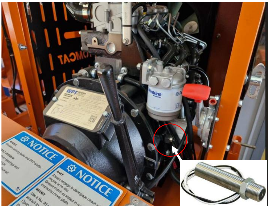
Рис. 6.2.1 Расположение магнитного датчика (отмечено красным цветом)
