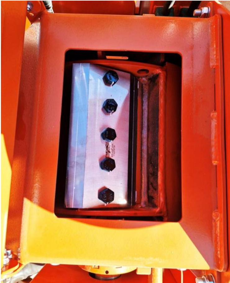
Рис. 6.15.1 Закрепленный на барабане нож измельчителя ТОМКАТ модель 4200
