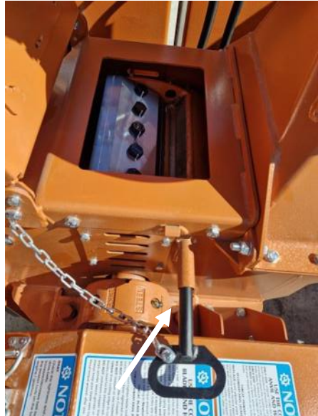
Рис. 6.16.3 Открытая крышка барабана при зафиксированном стопорном штифте
