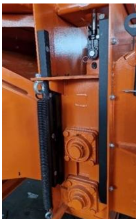
Рис. 6.7.3 Закрытый подвижный блок (нормальное использование)
