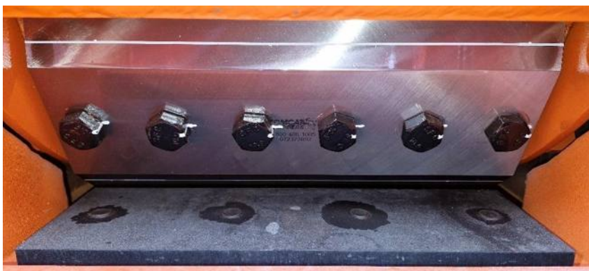
Рис. 6.10.4 Правильно установленный контрнож с зазором 3 мм
