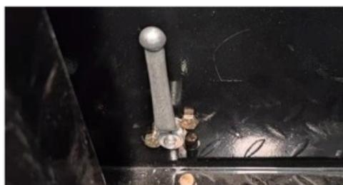
Рычаг крана аварийного опускания стрелы
