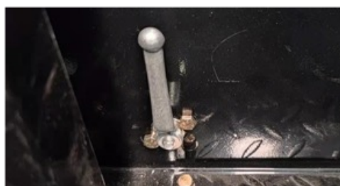
Рычаг крана аварийного опускания стрелы
