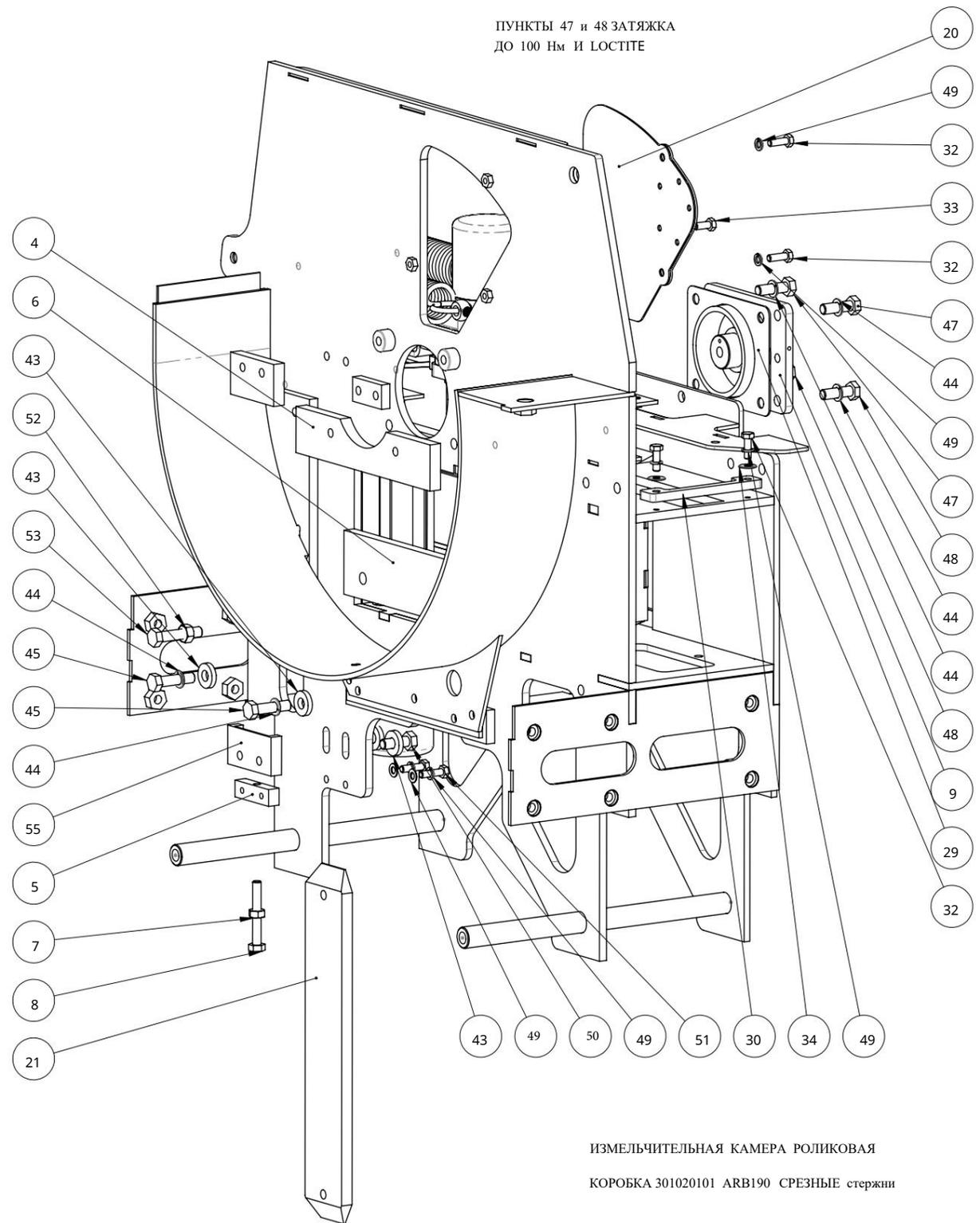
ИЗМЕЛЬЧИТЕЛЬНАЯ КАМЕРА РОЛИКОВАЯ
