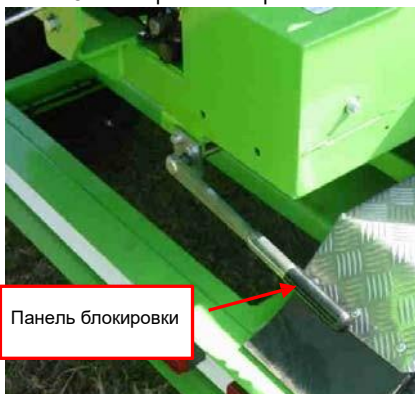
Рис 4.5 Блокировка поворотной панели
