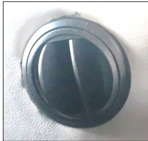
Рис. 27Д - Всасывающий захлопочный клапан отопления - открыт
