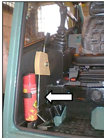
Рис. 5 - Место для укладки огнетушителя
