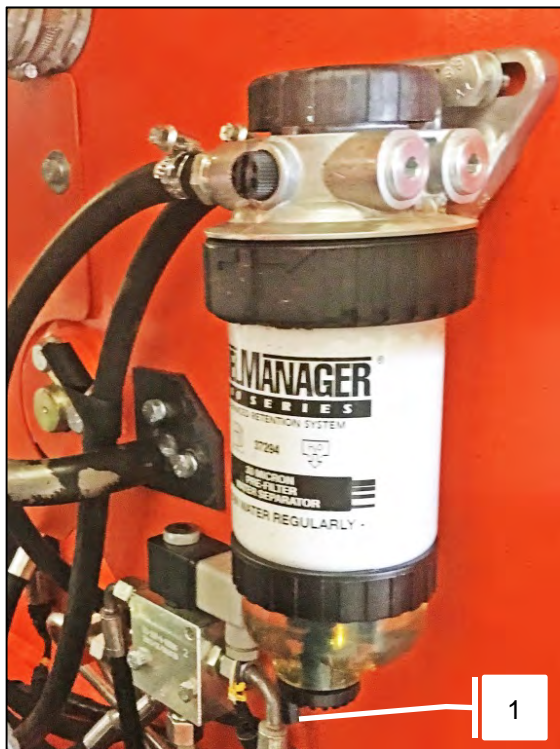
Рис. 35с- Фильтр грубой очистки топлива - слив воды из водоотделителя 1 - Сливной клапан и сливное отверстие
