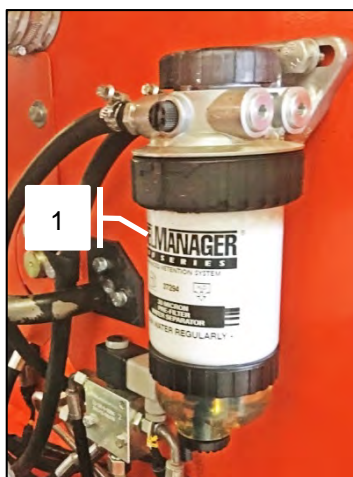
Рис. 35b - Топливная система 1- Фильтр грубой очистки, 2- Фильтр тонкой очистки, 3- Топливный насос ручной подкачки
