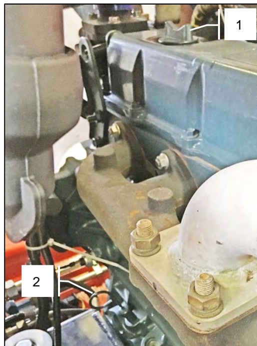
Рис. 30б - Заливка масла в двигатель 1- Пробка наливного отверстия, 2- Контрольный измеритель
