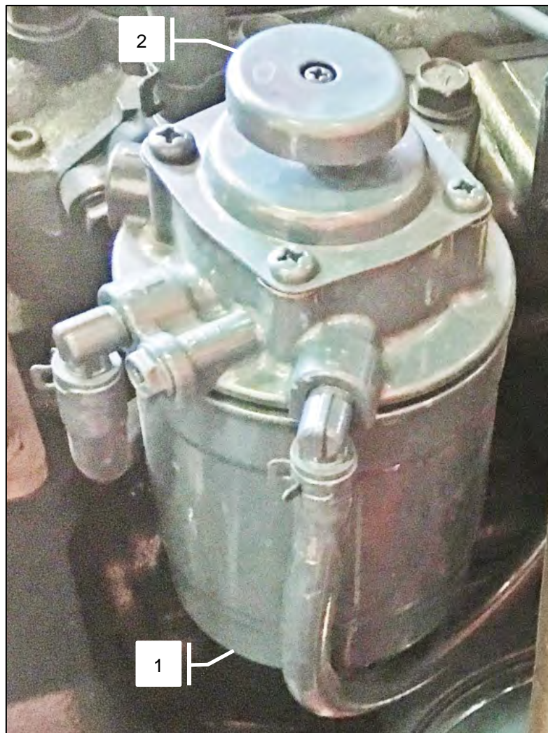
Рис. 35d- Топливный фильтр тонкой очистки 1- Фильтр тонкой очистки, 2- Топливный насос ручной подкачки
