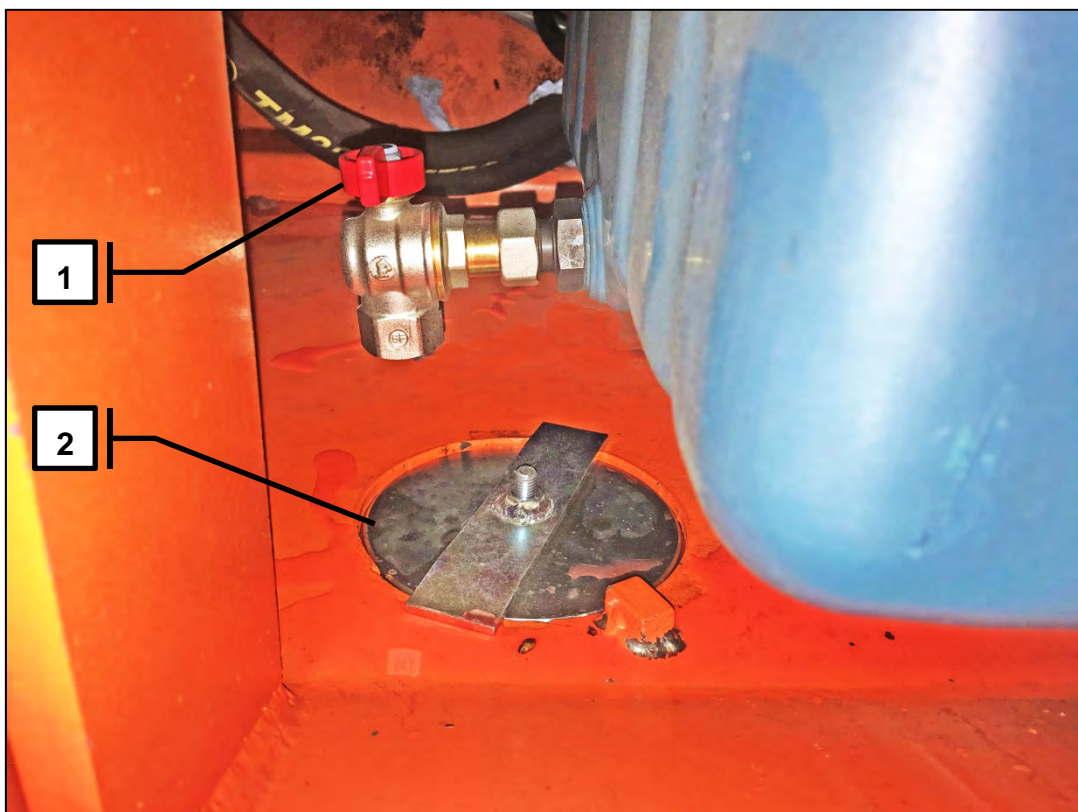
Рис. 31- Слив масла из двигателя 1- Сливной кран, 2- Крышка рамы
