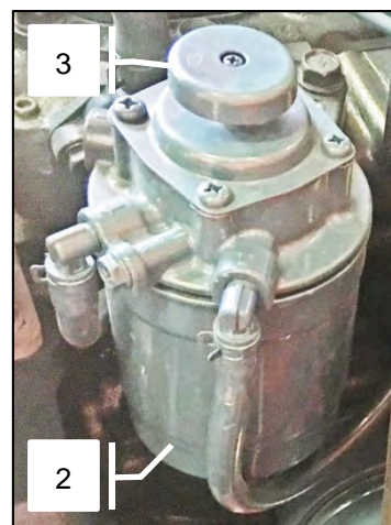
Рис. 35b - Топливная система 1- Фильтр грубой очистки, 2- Фильтр тонкой очистки, 3- Топливный насос ручной подкачки
