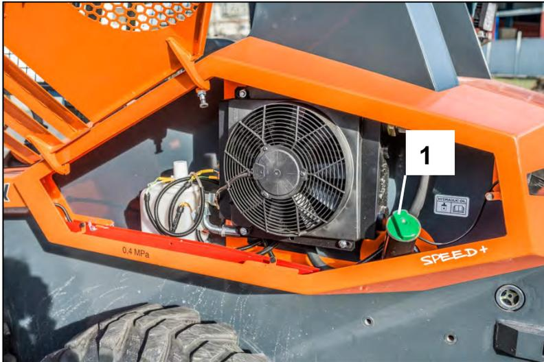
**Рис. 42 Заправка гидравлического масла**
