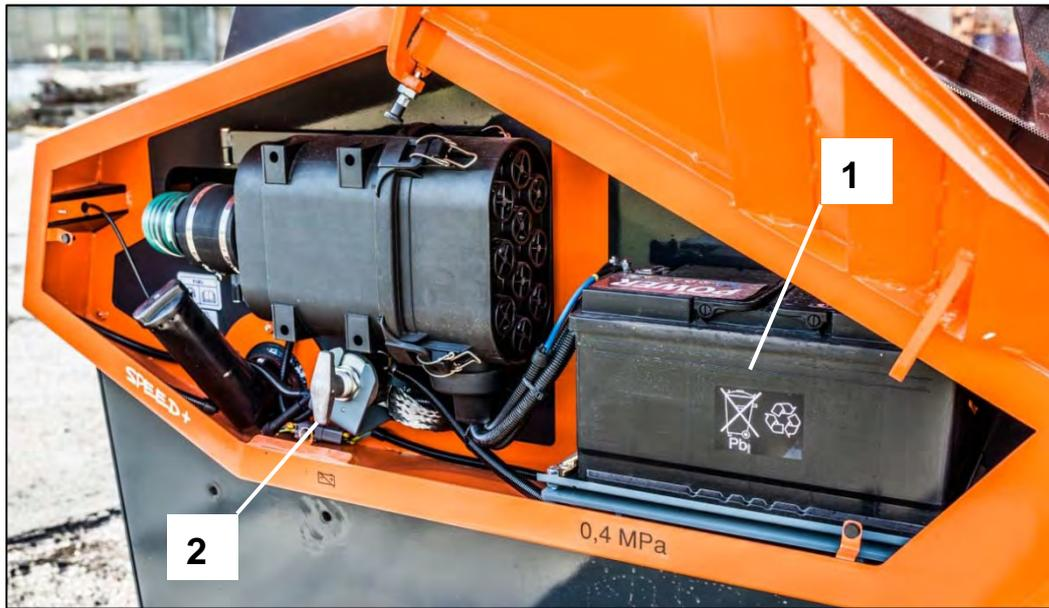
**Рис. 16- Расположение аккумулятора и разъединителя аккумулятора**
