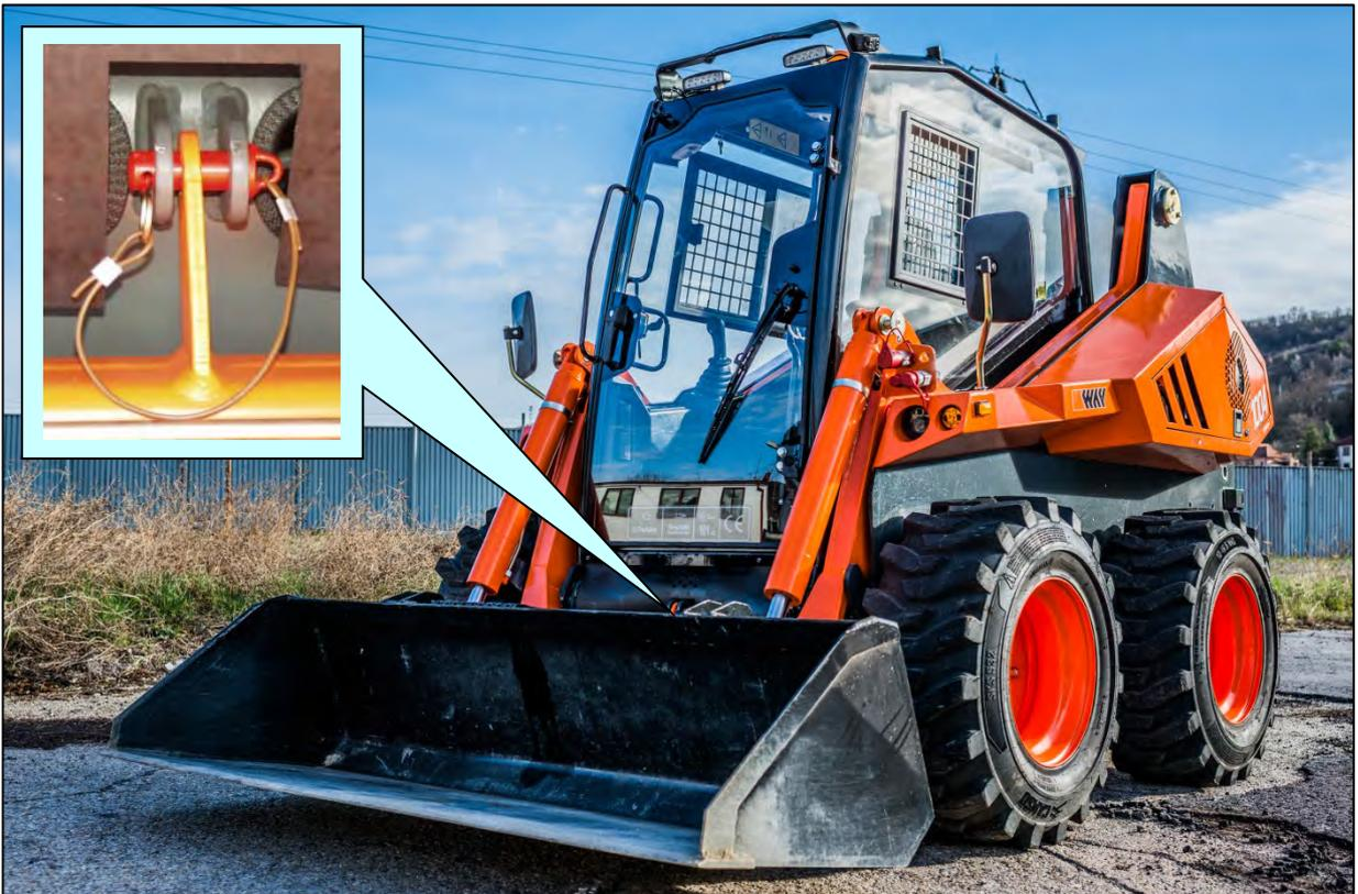
*Рис. 4 - Предохранительный штифт стрелы*
