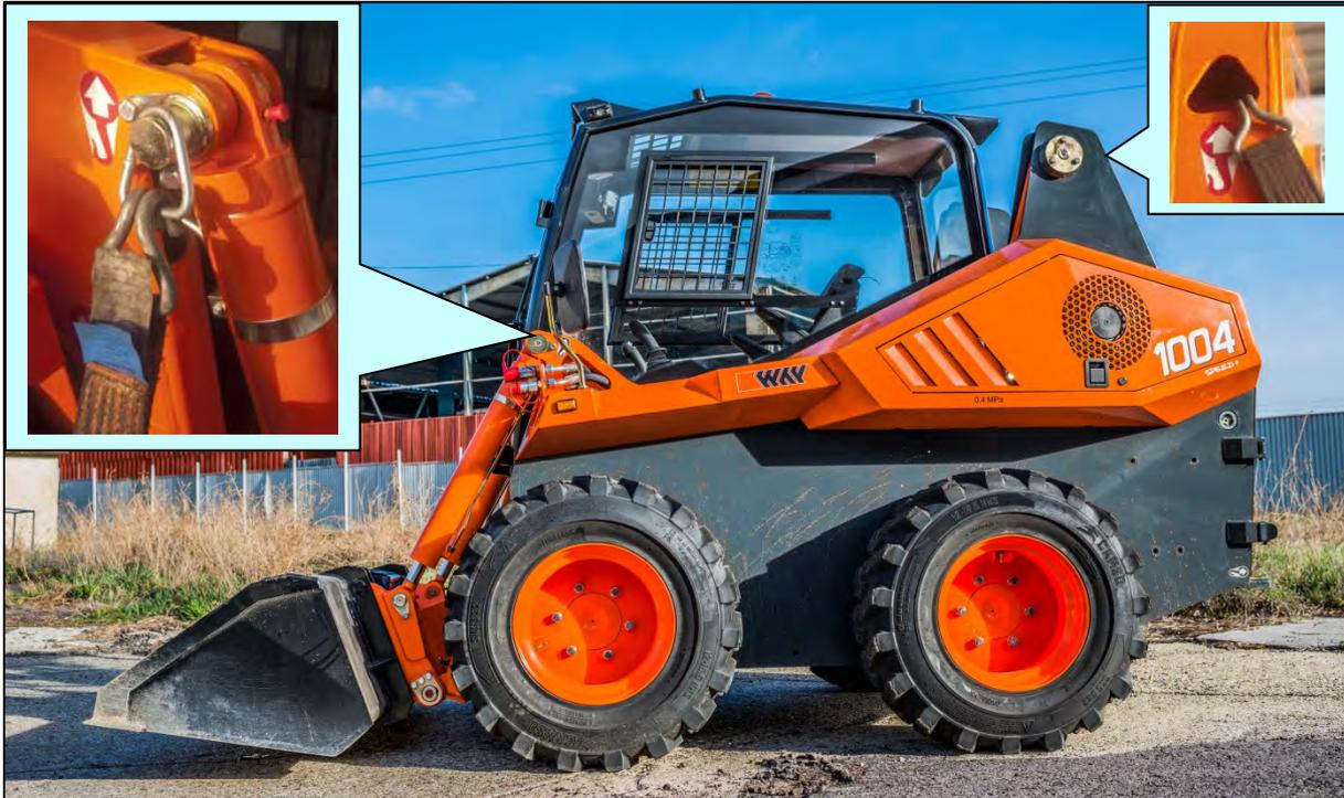
**Рис. 6- Транспортировка погрузчиков**
