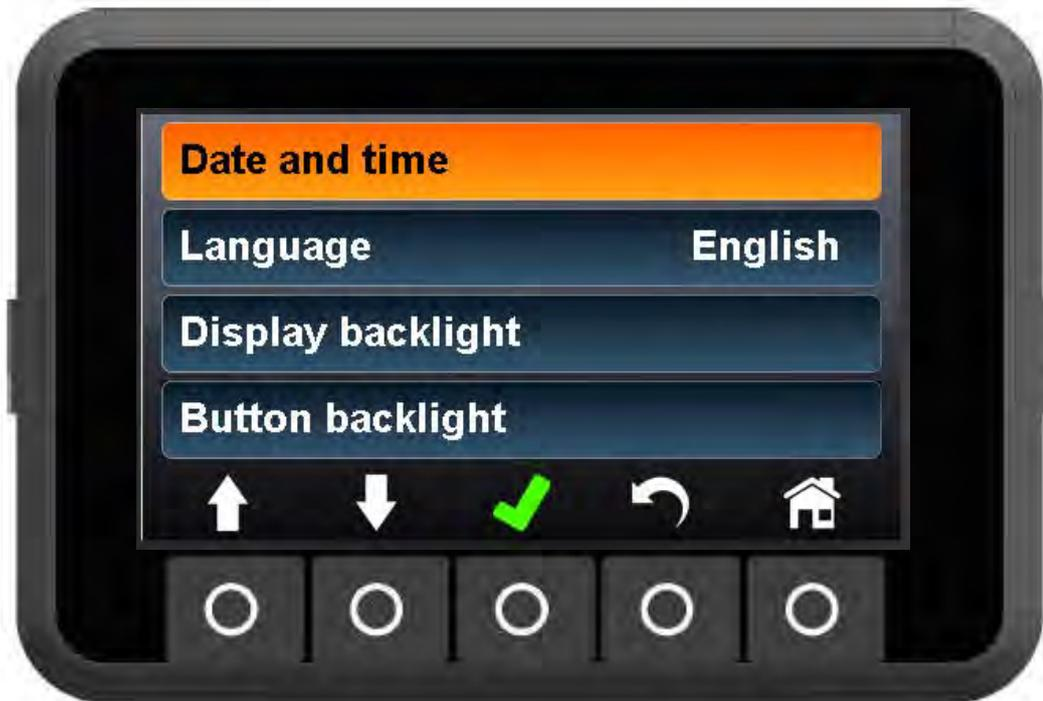
Рис. 25сг- Дисплей приборной панели – подменю "Настройки"
