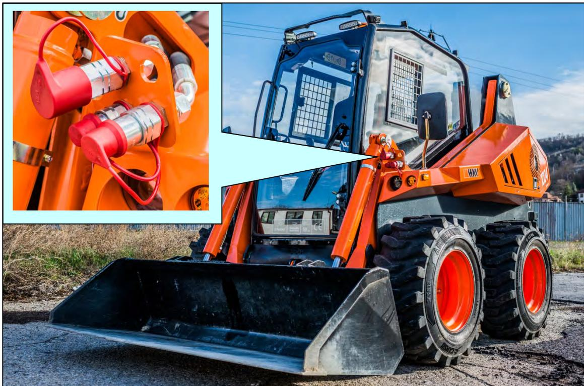
*Рис. 26f- Размещение быстроразъемных соединений*
