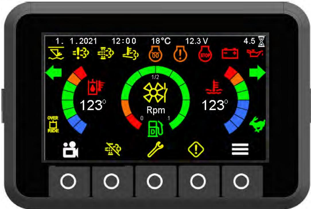
Рис. 25о- Дисплей приборной панели – вместо частоты вращения двигателя в центре дисплея появляется сообщение об ошибке "Открыт охладитель двигателя".
