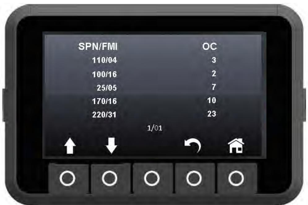
**Рис. 25п- Дисплей приборной панели – окно "Ошибки двигателя"**
