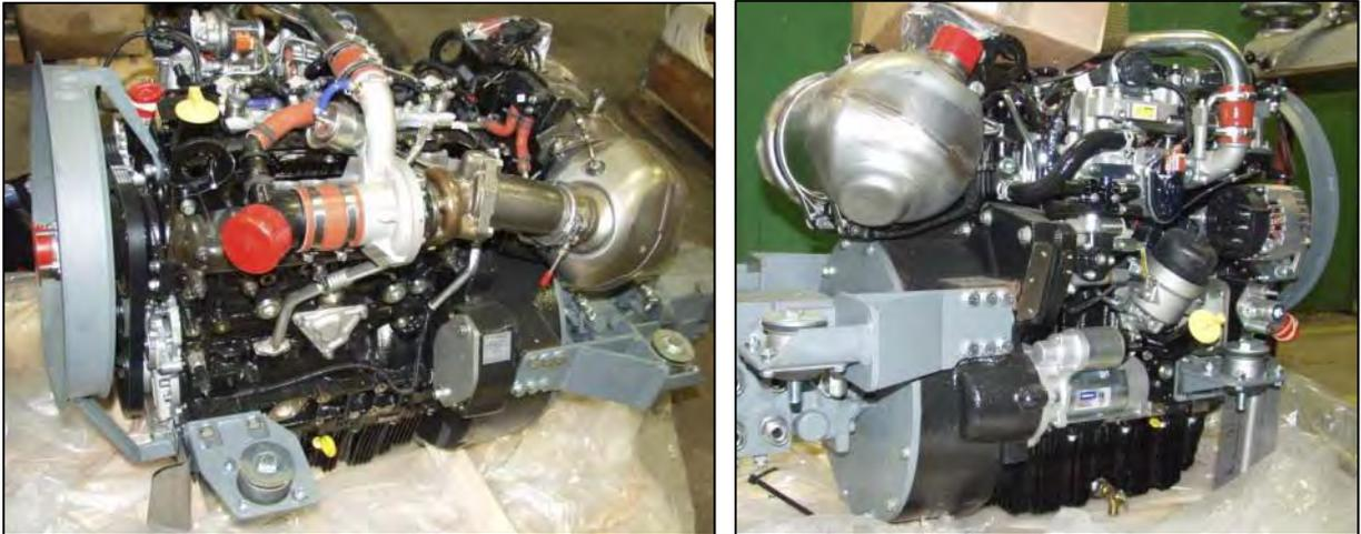
*Рис. 10 Двигатель PERKINS 904J-E28T*
