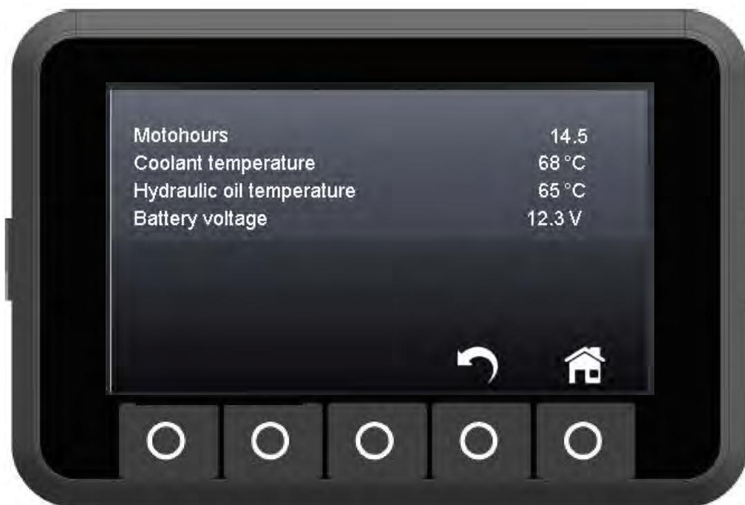
**Рис. 25е- Дисплей приборной панели – окно "Информация о машине"**
