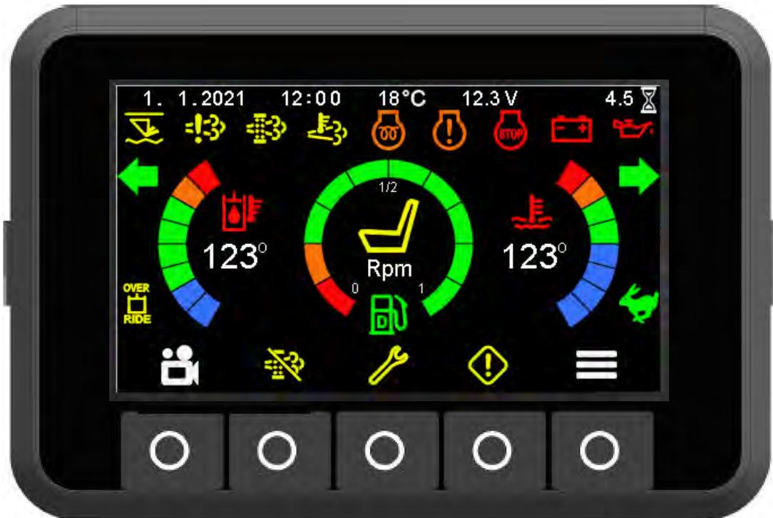
Рис. 25р- Дисплей приборной панели – сообщение об ошибке "Переключатель сидений"
