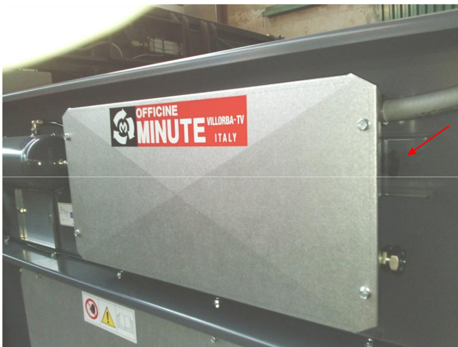
рис. 35 Нажмите грибовидную кнопку для пневматического открывания
