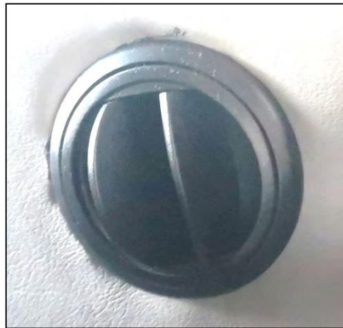
Рис. 27Д - Всасывающий захлопочный клапан отопления - открыт
