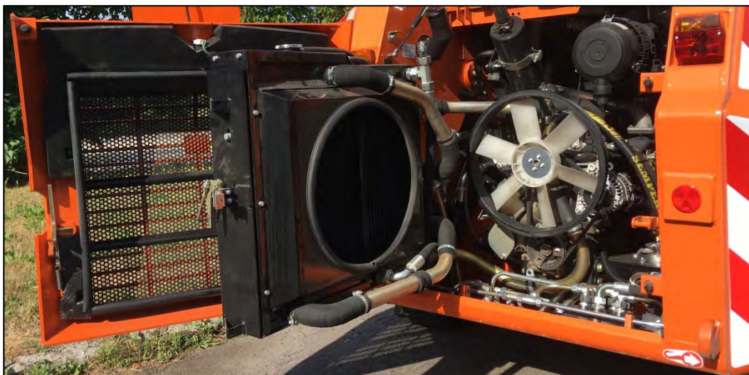
Рис.11 - Откинутый комбинированный радиатор
