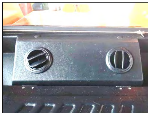
Рис. 27Ф- Выходные заплюпочные клапана отопления - открытые
