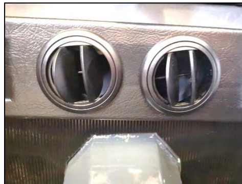
Рис. 27Х - Выходные заплюпочные клапана отопления - открытые
