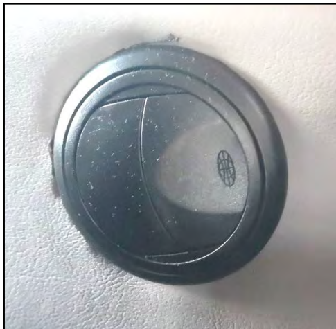
Рис. 27Ц - Всасывающий захлопочный клапан отопления – закрыт
