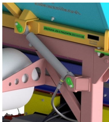
9 – Гидравлический цилиндр подъёма бункера
