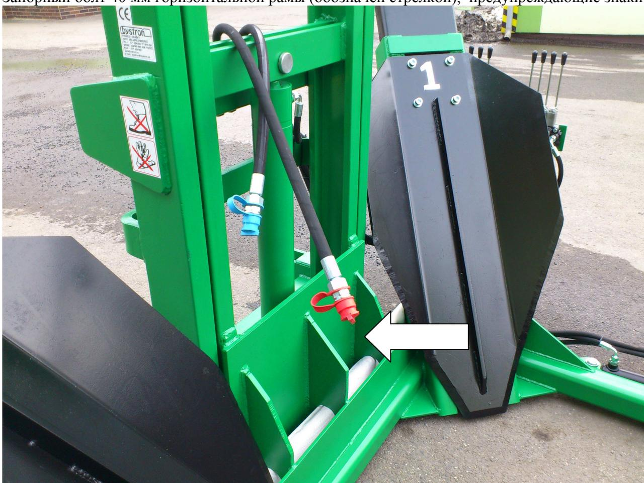
Шланги с быстросъемными муфтами для подключения к гидравлическому контуру трактора, жесткость соединения внутренней вертикальной и горизонтальной рамы обозначена стрелкой
