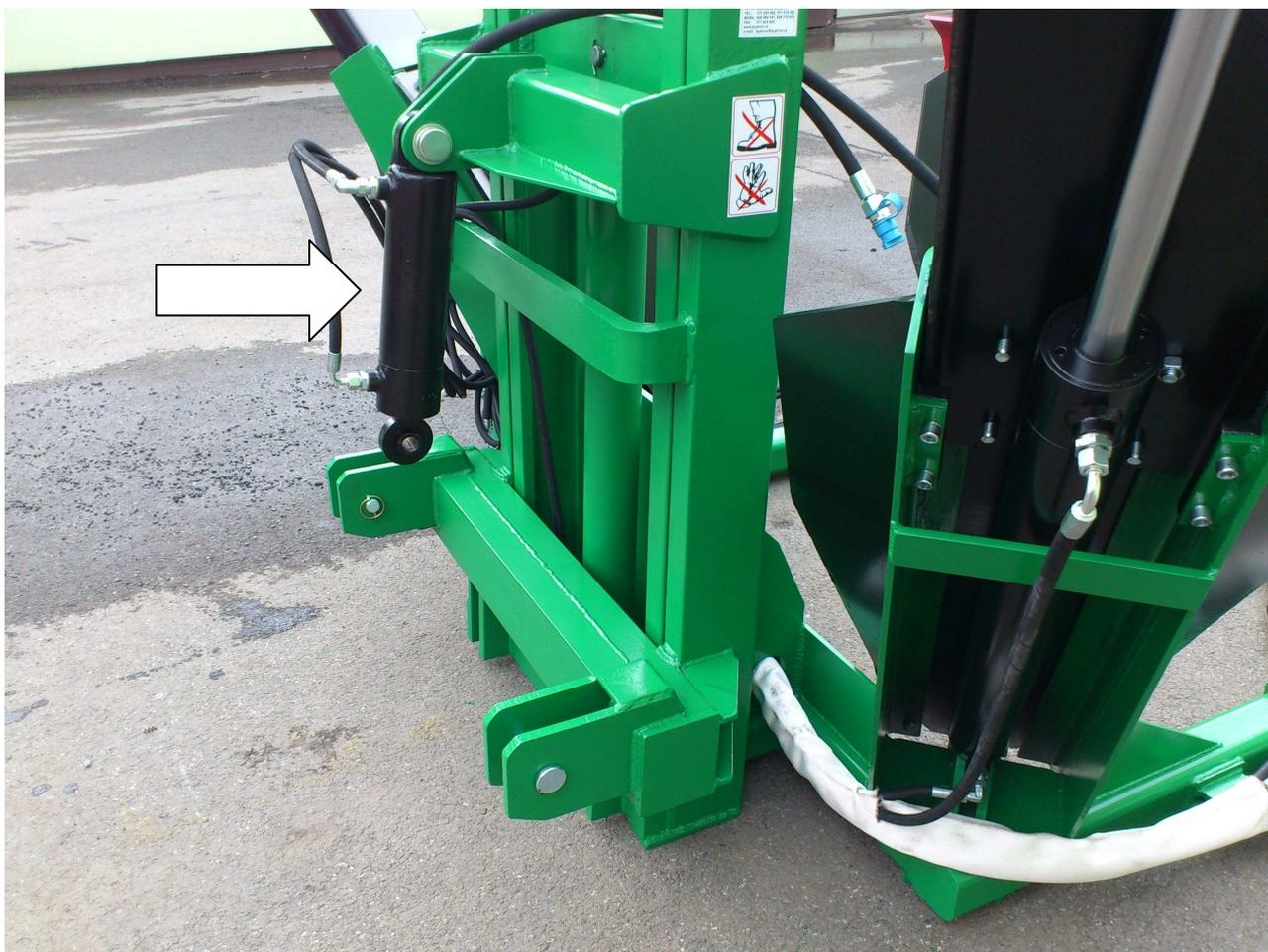
Наклонный поршень отмечен стрелкой, 3-точечная подвеска и стойки внешней вертикальной рамы
