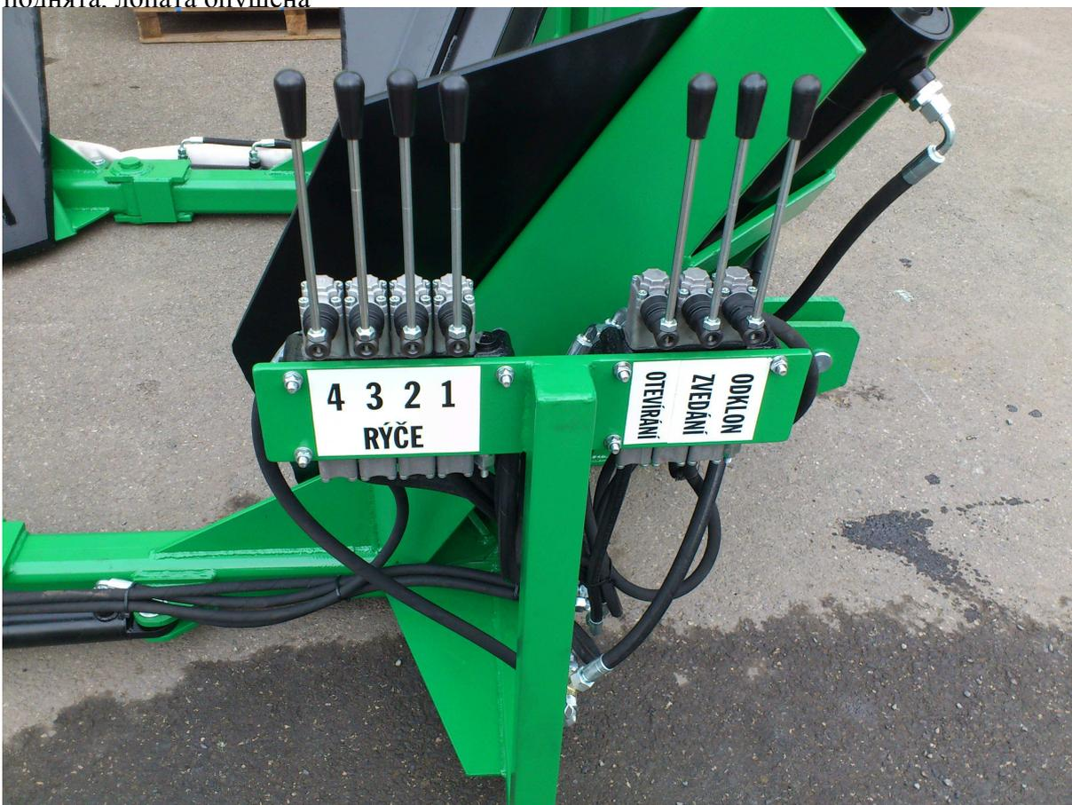
Приводные элементы: слева 4-секционные элементы, управляющие лопатами, справа 3-секционные элементы, управляющие открытием, подъемом и отклонением
