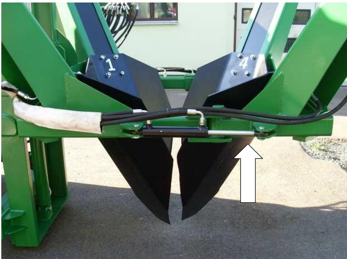
Горизонтальная рама закрыта, поднята над местностью, поршневой шток для закрытия рамы обозначен стрелкой
