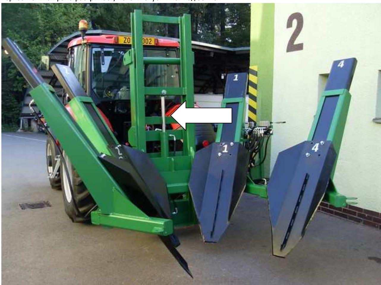
Лопата, поднятая над местностью, выдвинутый поршневой шток хода внутренней вертикальной и горизонтальной рамы, обозначенный стрелкой
