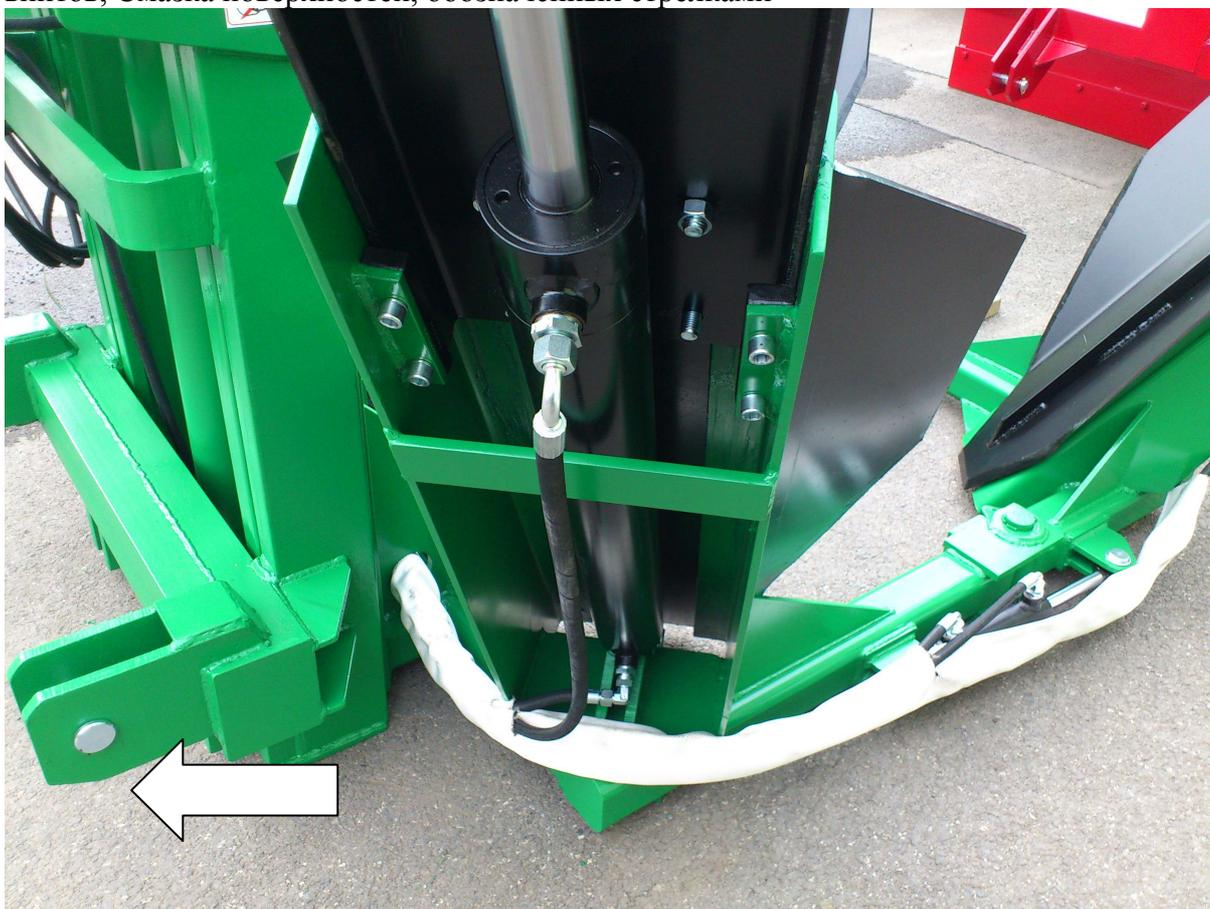
Расположение поршня хода лопаты в ноже горизонтальной рамы, с левой стороны нижней балки жесткости и нижнего места подключения. 3-точечная подвеска обозначена стрелкой
