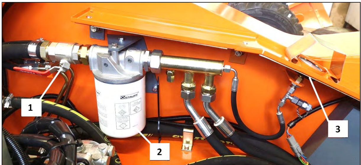
Обр. 38 - Местонахождение фильтра масла гидравлического контура ходового механизма 1 - Шаровой клапан, 2 - Фильтр масла, 3 - Индикатор загрязнения всасывающего фильтра (вакуумметр)
