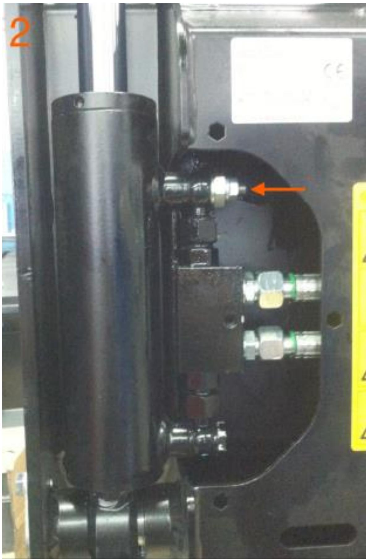
Установите калибровочную втулку так, чтобы открытая часть выходила примерно на 5 мм (см. рисунок 3)
