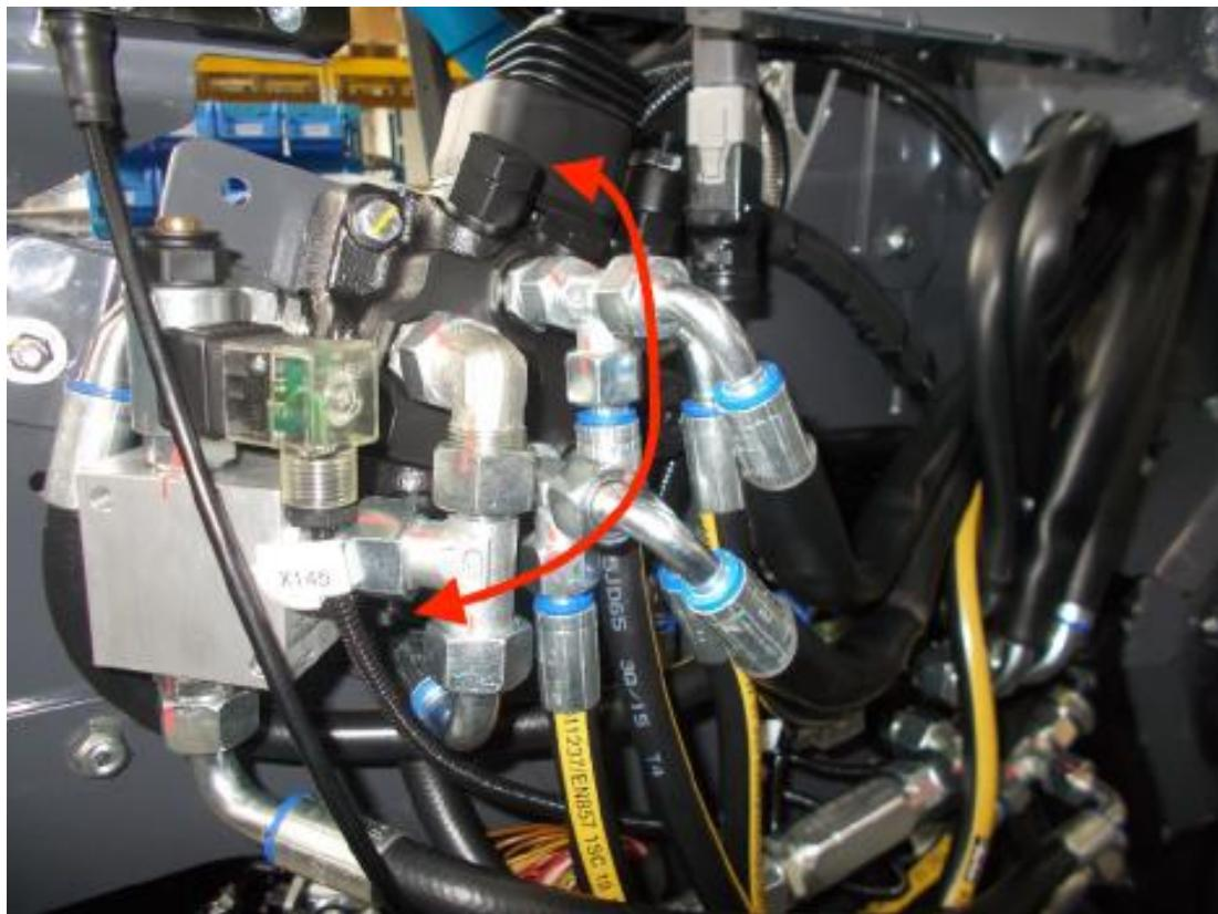
Если проблема не устраняется, попробуйте прочистить клапаны еще раз, в противном случае замените клапан на новый.
