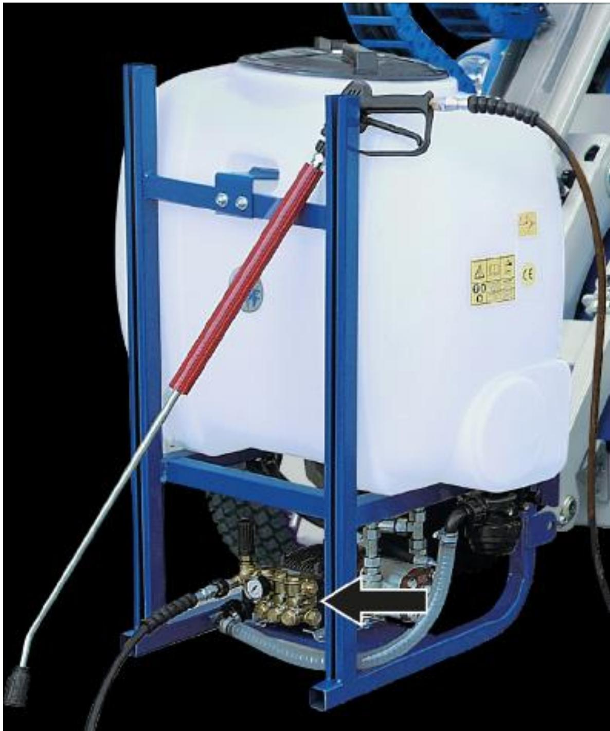
Снимите и почистите указанные предохранительные клапаны, поскольку засоры могут частично ослабить поток, не позволяющий обеспечить достаточное давление.
