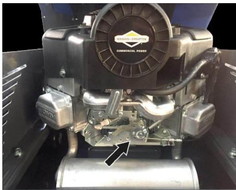
Убедитесь, что дроссельный провод прикреплен к верхней стороне фиксирующего зажима, как показано на рисунке. Если провод находится на нижней части фиксирующего зажима, ослабьте винт, удерживающий его с помощью гаечного ключа на 8, и установите его в правильное положение.
