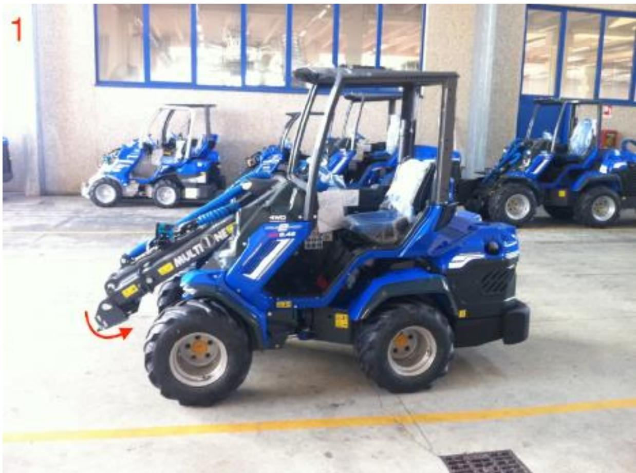
Поднимите стрелу вверх так, чтобы пластина была обращена вниз (рис. 2), и верните штангу назад до упора, на несколько секунд сдвинув ее в крайнее положение, чтобы клапан сброса максимального давления выводил воздух из контура (рис. 3).
