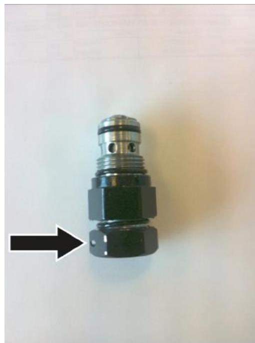
Нажмите на заднюю часть клапана, чтобы открыть его, и продуйте сжатым воздухом, как показано красными стрелками.
