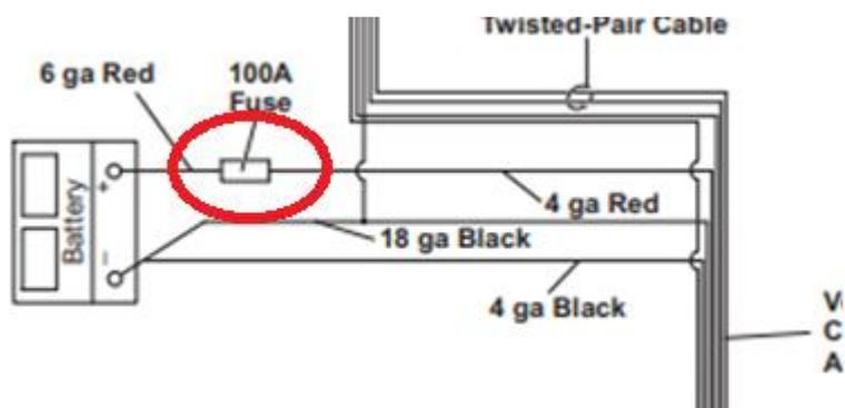
2. Ее нужно вскрыть, перед предохранителем есть клемма, к которой необходимо подключить красный провод:
